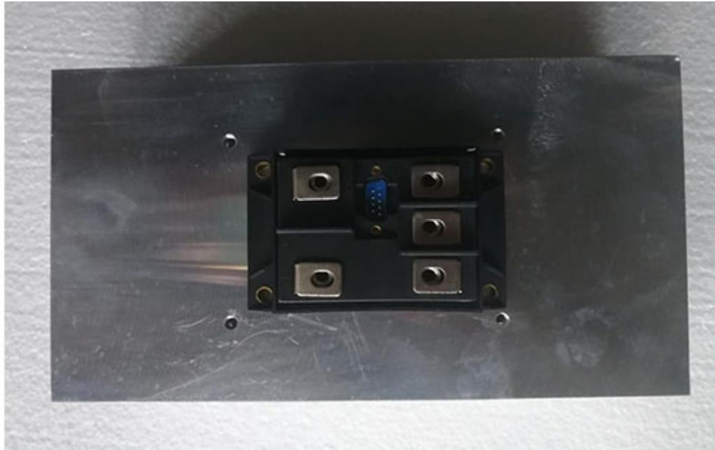
来保持炉内温度恒定二、可控硅智能调压模块的选择可控硅智能调压模块是由电加热炉控制装置中关键的功率器件，整机装置是否工作可靠与正确选择可控硅智能调压模块的额定电压、额定电流等参数有很大关系，选型的原则是考虑工作可靠性，即电流、电压必须留有足够的余量。一般加热炉额定电压为380V，选择工作电压为460V的晶闸管智能模块，其他电压的可控硅智能调压模块需要订做。对可控硅智能调压模块电流的选择，必须考虑加热炉炉丝（或加热件）的额定工作电流及可控硅智能调压模块的输出电压值，如果加热丝为NTC或PTC特性的（即加热丝额定电流随温度变化，开机时温度很低，额定电流会很大或加热到较高温度时，额定电流会很大或加热到较高温度时，额定电流会很大），必须考虑加热丝整个工作状态的电流值，作为加热丝的额定电流值来确定可控硅智能调压模块的规格大小。淄博正高电气不断从事技术革新，改进生产工艺，提高技术水平。德州进口晶闸管调压模块型号
